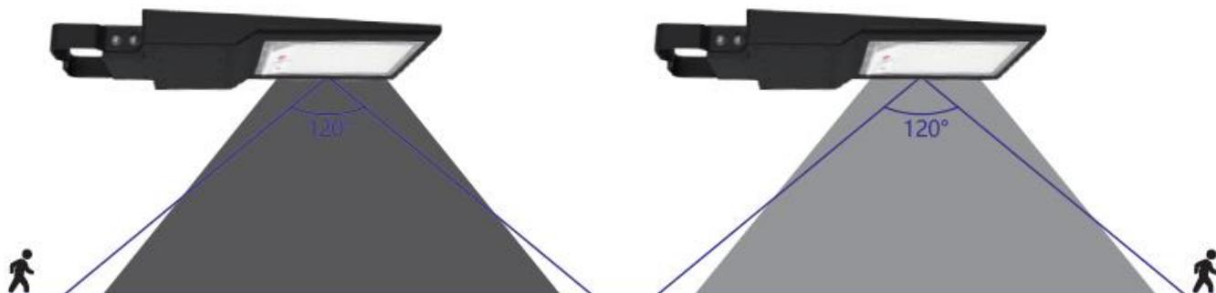
Alla prima pressione del pulsante il proiettore lampeggia una volta per segnalare l'entrata in funzione in **Modalità 1**. Il proiettore si accende al 100% dell'emissione luminosa quando viene rilevato movimento nel raggio d'azione del sensore (120°-8/10m) per poi passare al 4% dell'emissione luminosa 20 secondi dopo l'ultimo movimento rilevato. Il funzionamento avverrà fino all'alba o all'esaurimento della batteria.
