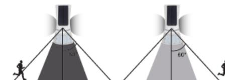
Quando la batteria è carica (>30%), al crepuscolo (<30lux), la lampada si accende alla massima luminosità (240lm) quando il sensore rileva ad un distanza ≤6 m un movimento. Dopo 10 secondi senza rilevamento, automaticamente si posiziona al 20% con luce frontale e posteriore
